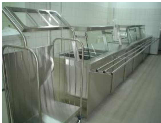
Przykład ciągu wydawczego produkcji Gort S.A. na obiekcie — wykonanie w całości stal nierdzewna z elementami szklanymi.
